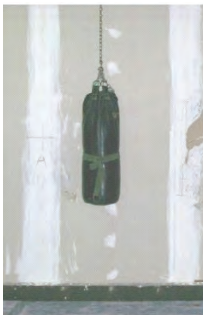
Figura 4 – Impacto de corpo mole transmitido por saco de couro com massa de 40kg.
