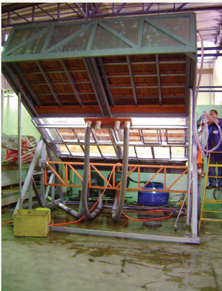
Figura 26 – Câmara para ensaio de estanqueidade de coberturas em laboratório (Fonte IPT).
