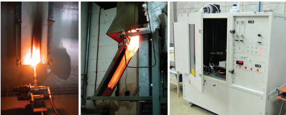
Figura 9 - Equipamentos para ensaios de ignitibilidade, propagação superficial de chamas e densidade ótica de fumaça (Fonte: IPT)
