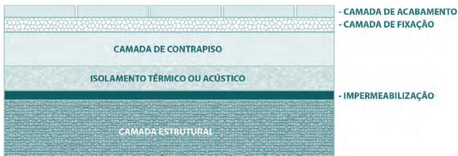
Figura 11 – Camadas integrantes de um sistema de pisos genérico (Fonte: NBR 15785)
