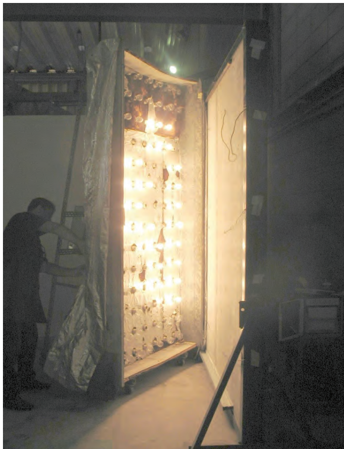
Figura 28 – Painel radiante para ensaio de choque térmico em parede de fachada (Fonte: IPT)
