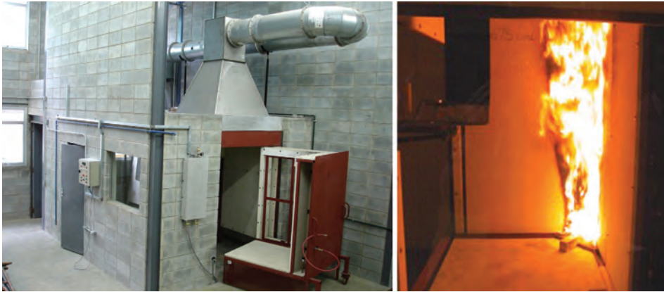
Figura 10 – Ensaio SBI – Single Burning Item de acordo com a EN 13823 (Fonte: IPT)
