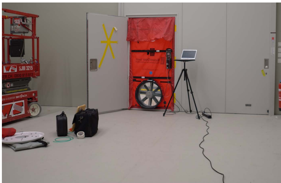
Blower-door test sendo realizado. Foto por airtight junkies - CC BY 2.0
